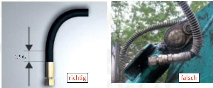
Abbildung 8: richtig - Gerader Abschnitt mit 1,5 d_a vor Biegung falsch - Eine Schlauchscheuerschutzspirale stellt keinen Knickschutz dar
