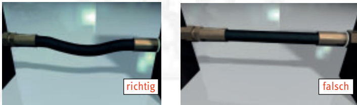
Abbildung 13: Einbaulänge
