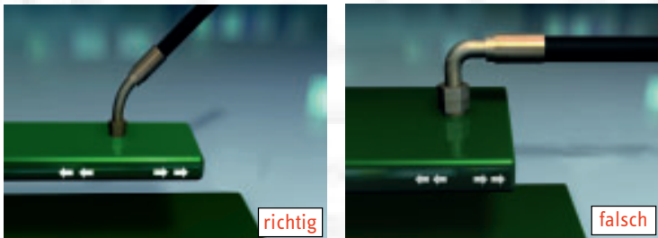
Abbildung 15: Verlegung bei Schwingungen
